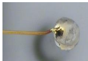
Microelectrode array (1mil Au wire)
